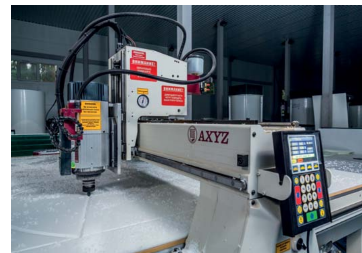
Раскрой деталей для сборки «Евробион» на фрезерном станке с ЧПУ
